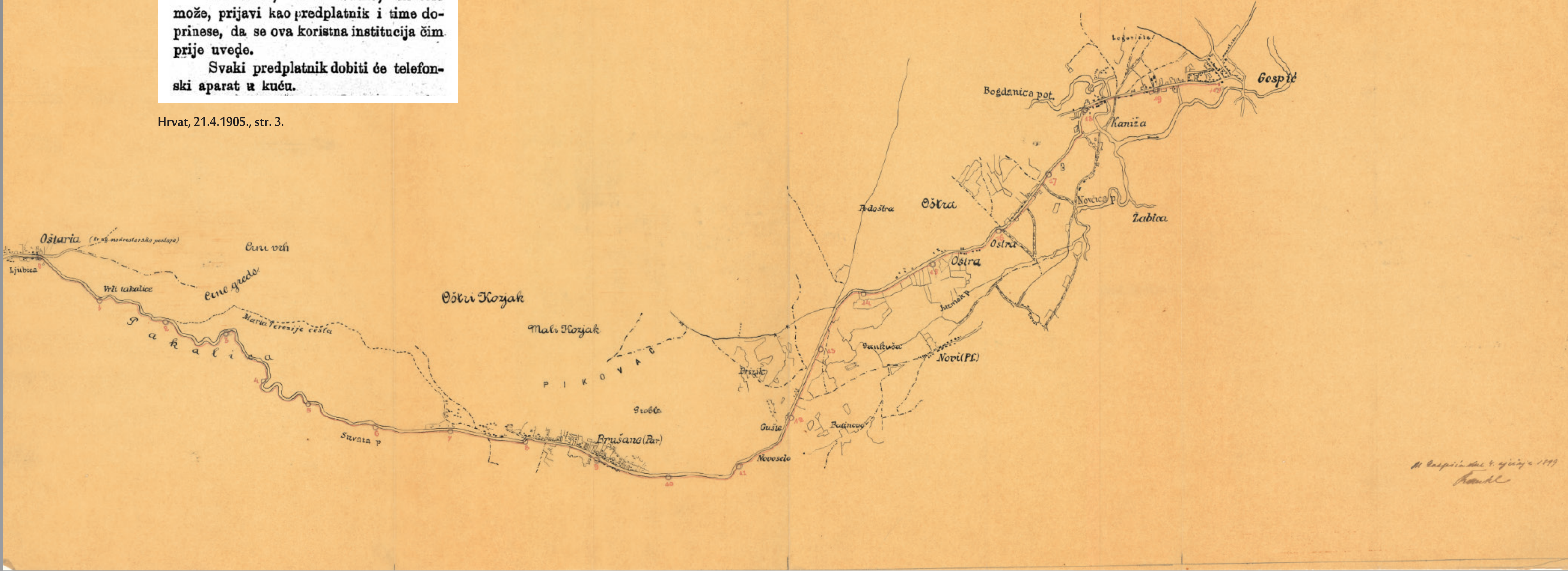
Nacrt za izgradnju telefonske linije Oštarije-Gospić iz 1899. godine. HR-HDA-79. Zemaljska vlada. Odjel za unutarnje poslove.
